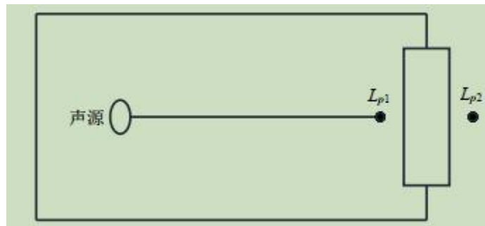
图 4.4 室内声源等效为室外声源图例
